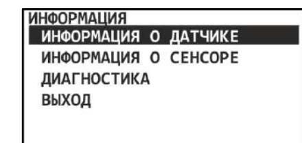
Меню «Информация» содержит информацию о газоанализаторе и сенсоре, а также данные диагностики прибора. Полученные данные при неисправности прибора необходимо сообщать в службу технической поддержки предприятия-изготовителя, они помогут выявить причину неисправности. Для редактирования пользователем доступен пункт - Диапазон показаний, остальные доступны только для чтения, либо редактируются специалистами предприятия-изготовителя и помечены значком .
