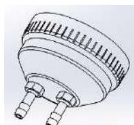
③ Комплект для монтажа на трубу\*. Позволяет установить газоанализатор
