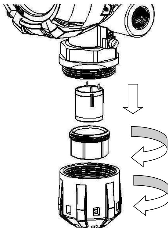
Рисунок 15 – Схема разборки при замене сенсора
