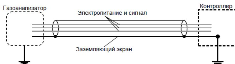
Рисунок 13 – Заземление экранированного кабеля
