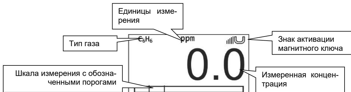
При поднесении магнитного ключа к значку (на лицевой панели прибора) на дисплее отображается график, показывающий измеренную концентрацию за последнее время работы газоанализатора. Интервал движения графика настраивается в меню (Меню ► Настройка ► Интерфейсы ► Дисплей). Для выхода обратно в режим измерения необходимо поднести магнитный ключ к этому же значку или к значку .
