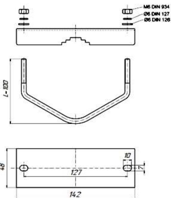
Рисунок 7 – Вид крепления для установки на трубу
