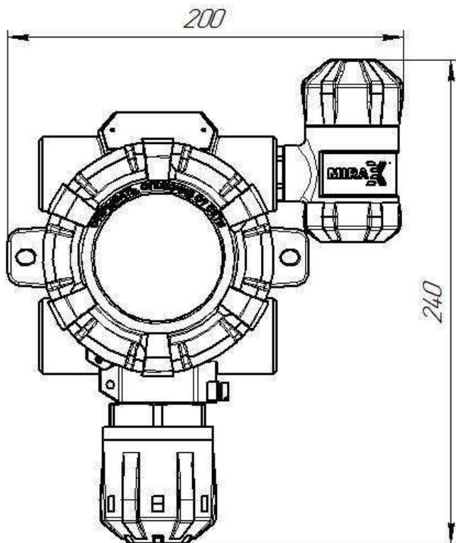
Рисунок 2 – Габаритные размеры АХИОМ
