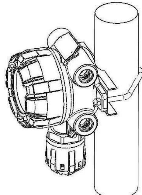
Рисунок 8 – Вид газоанализатора, установленного на трубу
